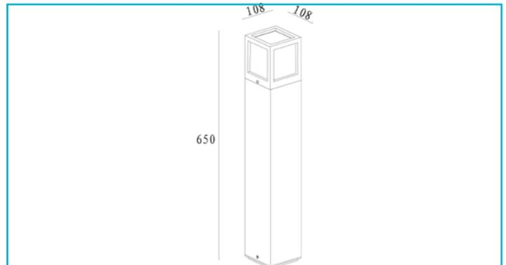
Die Stehleuchten der FACADO-Serie finden bereits seit einiger Zeit auf gepflasterten Gehwegen im Gartenbereich Verwendung. Mit der FACADO werden die klassischeleganten Außenleuchten (IP44) noch vielseitiger. Dank E27-Sockel lässt sich das Leuchtmittel bei Bedarf wechseln und an die gewünschte Lichtstimmung anpassen. Die FACADO ist in zwei Höhenausführungen (65 und 100 cm) erhältlich.
