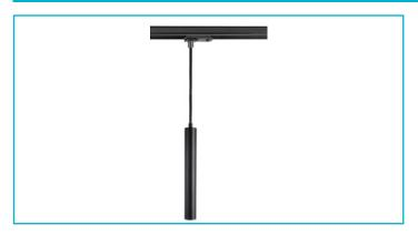
Für das Stromschienensystem gibt es passende Pendelleuchten der SLIM - Serie. Der Leuchtenkorpus aus Aluminium-Druckguss ist dabei immer gleich groß [300 x 39mm]. Die Pendelleuchten für die Stromschienen ermöglichen eine Abhängung von maximal 1800 mm.
