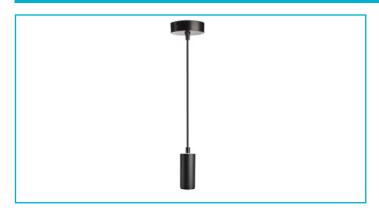
Die Pendelleuchten der LUCEA-Serie sind in den Versionen 10, 15, 20 W erhältlich und bieten bis zu 2.000 Lumen Lichtleistung. Die maximale Abhängung beträgt 1.600 mm. Über optionale Linsen lassen sich die einzelnen Modelle in ihrem Abstrahlwinkel verengen oder erweitern. Das Gehäuse der LUCEA-Leuchten besteht aus Aluminium-Druckguss.
