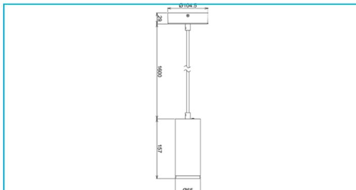
Die Pendelleuchten Dim-to-warm der LUCEA-Serie sind in 10 W erhältlich und bieten bis zu 750 Lumen Lichtleistung. Die maximale Abhängung beträgt 1.600 mm. Über optionale Linsen lassen sich die einzelnen Modelle in ihrem Abstrahlwinkel verengen oder erweitern. Das Gehäuse der LUCEA-Leuchten besteht aus Aluminium-Druckguss.
